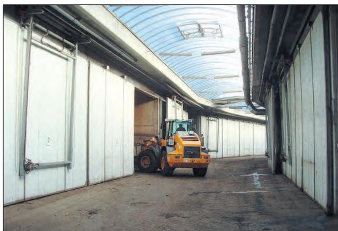
**Blick in die Fahrgasse mit rechts und links angeordneten Rottetunneln**
