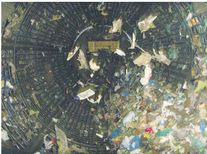
Blick in das Trommelsieb
