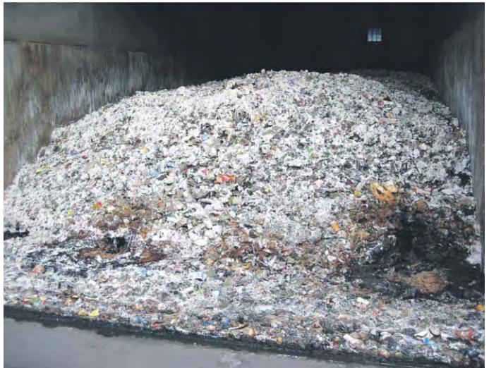
Blick in einen Rottetunnel
